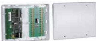
Transceiver hilock 203 mit Lötverteiler im Gehäusotyp K30
