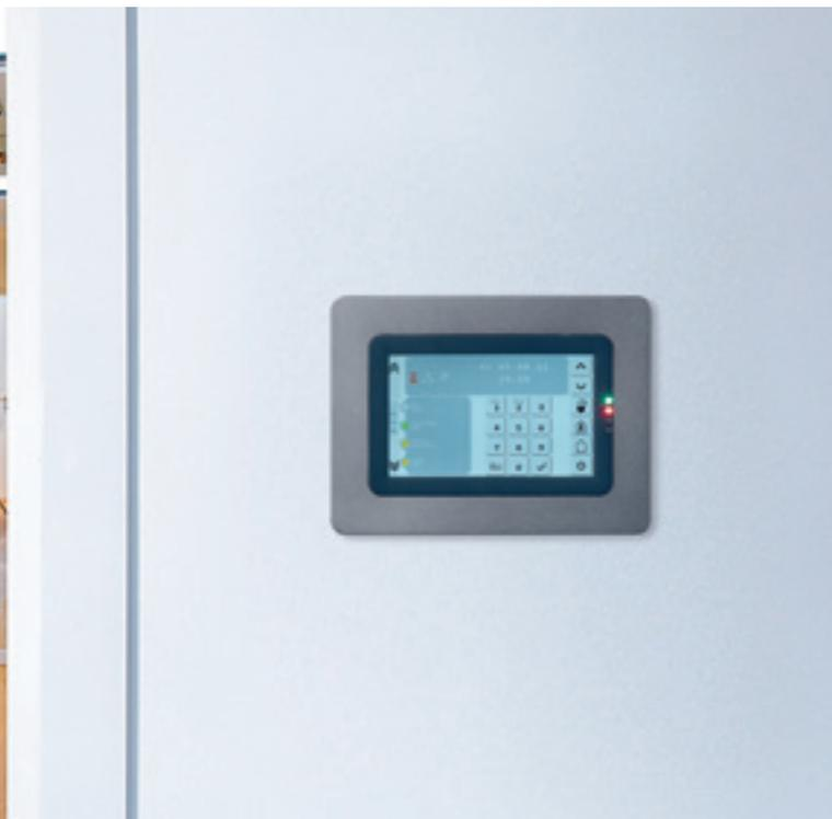
In dem Einfamilienhaus steuern die Bewohner die Anlage am stationären sowie mit einem mobilen Bedienteil, welches das Steuern der Alarmanlage von jedem Zimmer aus ermöglicht. Am stationären Bedienteil lassen sich zudem alle Statusinformationen der Anlage und ihrer Melder ablesen.
